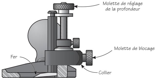
**Figure 2 : Installation du fer**
