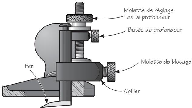
**Figure 4 : Butée de profondeur**
