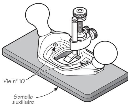
Figure 8 : Semelle auxiliaire
